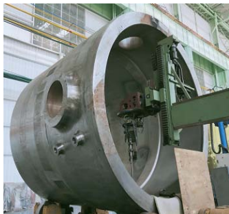
RPV支承段筒体堆焊
