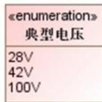
28V: 功率需求<=1.5kW的航天器, 或1.5kW~2.5kW的航天器在设计时已考虑负载继承性
