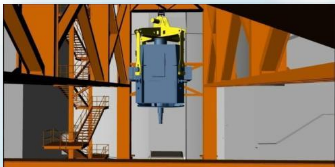
运输吊装三维模拟
