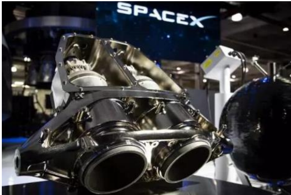
LAS系统推进系统发动机整合设计（喷油、冷却、节流一体化）
