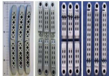
A320客机上应用全新结构轻量化隔框
