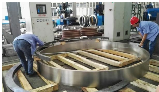
2016年主容器解剖件 \phi 3.5\text{m}
