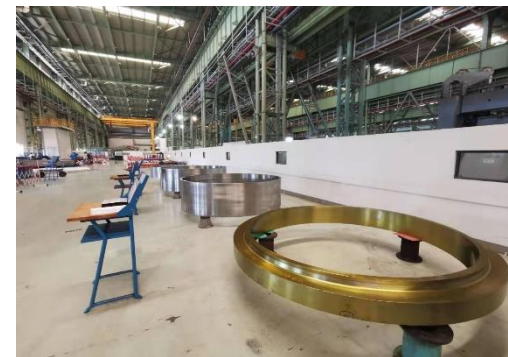
2018年环轧件 \phi 2\text{m} , 高度 大于1100mm
