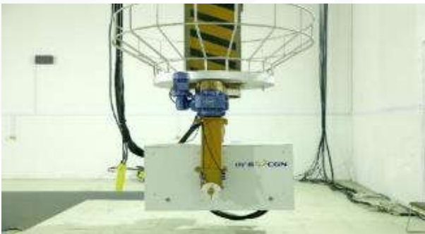
无损检测(6MeV加速器和100居里钴源)
