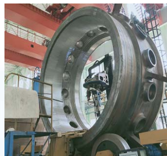
RPV容器法兰堆焊
