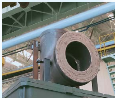
RPV主泵接管待堆焊
