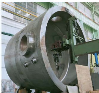
RPV支承段筒体堆焊
