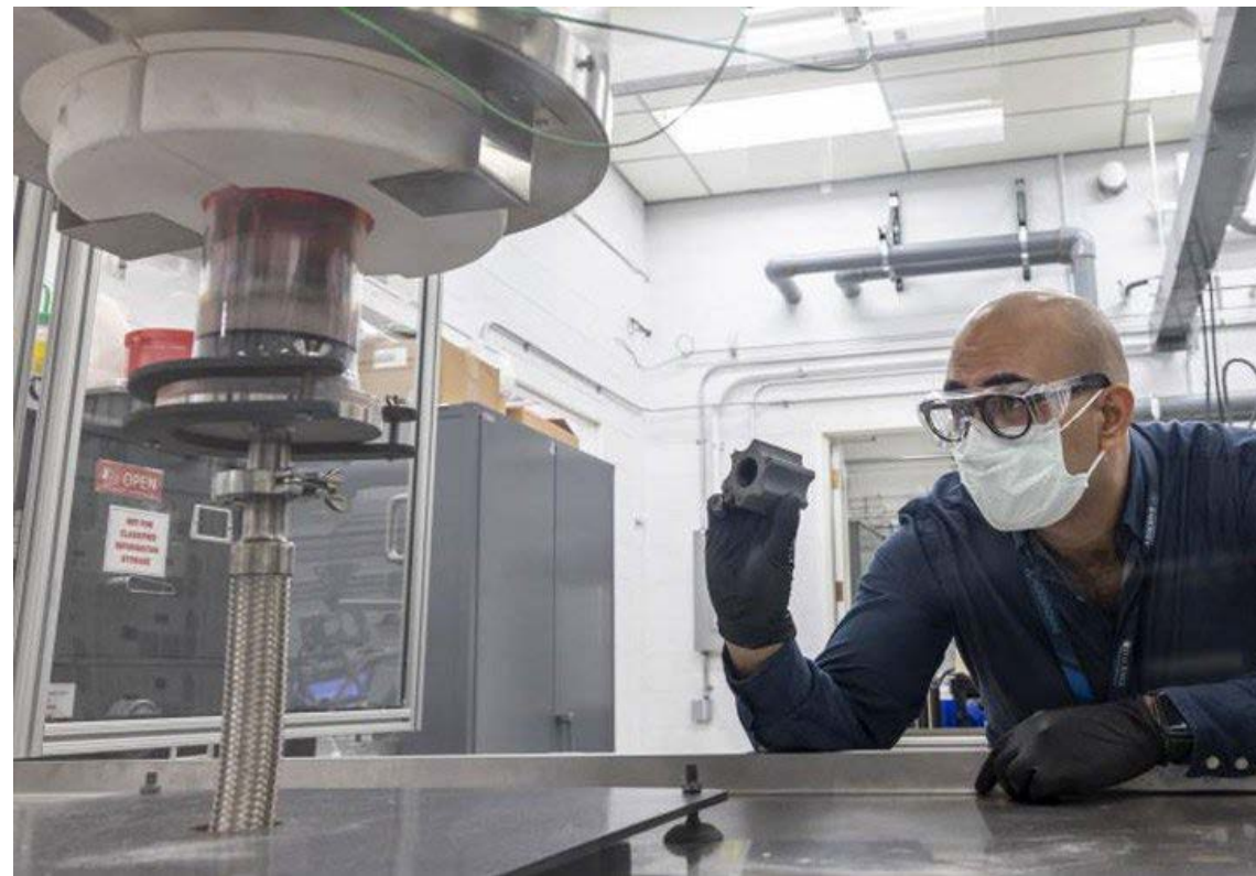
美国超安全核能公司粘结剂喷射打印机制造碳化硅陶瓷增强燃料棒体过程
